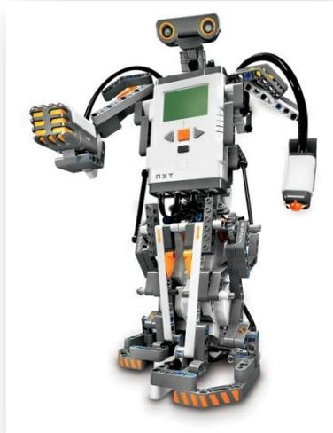
**Abbildung 4: Ein Roboter realisiert mit Lego MINDSTORMS NXT**
